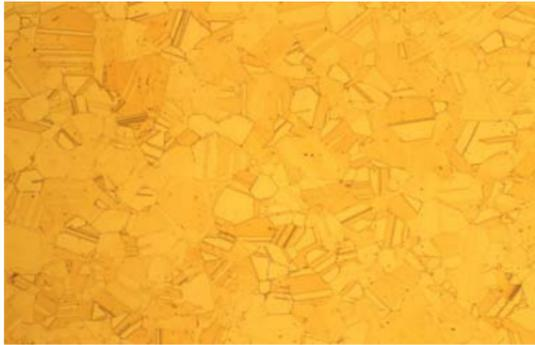
**Figure 11-11a** 70-30 Brass, 200X (B.F.), Etchant  $\text{H}_2\text{O}_2$  /  $\text{NH}_4\text{OH}$
